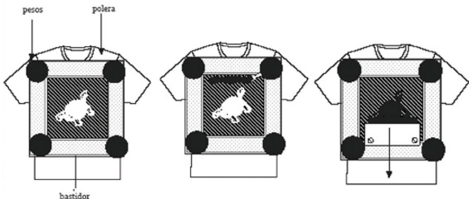
La tela de tiene que estar muy tensa y sin arrugas. Pondremos un poco de tinta para serigrafía sobre la pantalla y con ayuda de la paleta le pasaremos primero en dirección horizontal y después en vertical, y separaremos con cuidado la pantalla de la tela, ya que esta se quedara medio pegada por la tinta. Lo dejaremos secar al aire y cuando este seco lo plancharemos con una plancha sin vapor. No podremos lavar esta prenda en 8 días.
