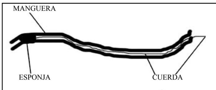
una cuerda, esta cuerda irá por dentro de la manguera y saldrá por el otro extremo. Debes tener en cuenta que las paredes de dentro de la manguera sean lisas y que la esponja entre bien en la manguera y se deslice con facilidad tirando por el otro extremo de la cuerda. Es simple, como si construyeras una jeringuilla a gran escala. Cuando la tengas bien hecha y hayas hecho pruebas
