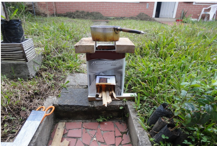
Fogão roquete construído apenas com latas de tinta
