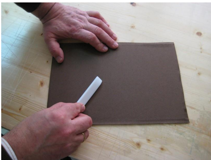
Repaso con la plegadera
