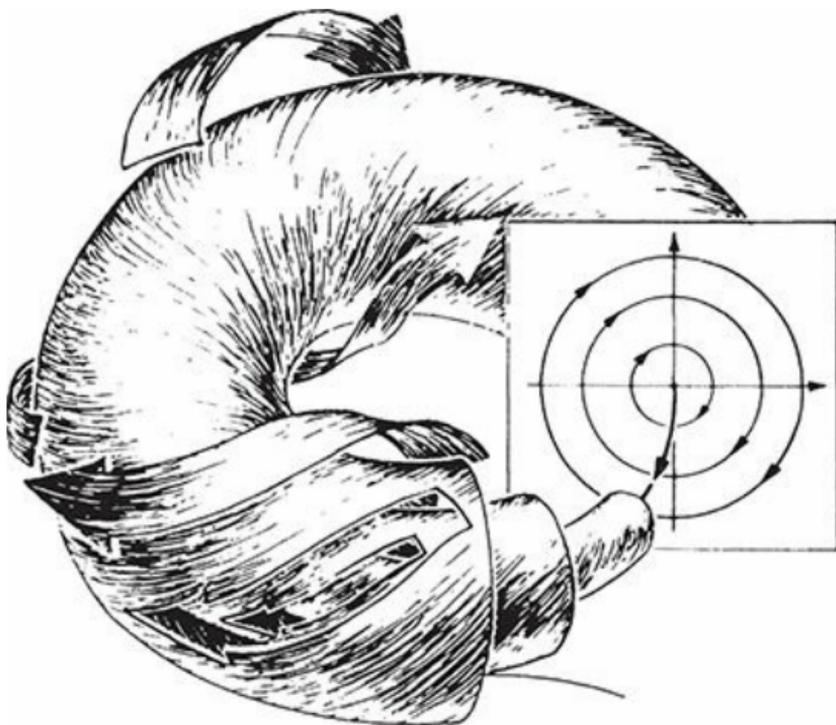
FIGURA 107. A figura clássica de uma seção de Poincaré nas proximidades de uma trajetória periódica. Cada círculo representa um movimento quase-periódico com dois períodos diferentes.
