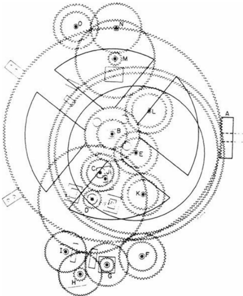
FIGURA 8. Engrenagem do mecanismo de Anticitera, antigo calculador planetário grego.
