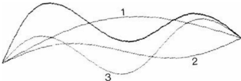
FIGURA 13. Vibração de uma corda de violino: senoide fundamental (1) e seus segundo e terceiro harmônicos (2, 3), superpostos para criar uma onda mais complexa (linha cheia).
