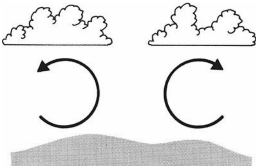
FIGURA 53. Células de convecção, causadas pela subida do ar quente.
