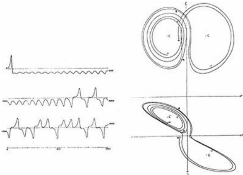
FIGURA 54. Gráficos feitos por Lorenz, representando 3.000 passos numericamente computados em suas equações para a convecção: (à esquerda) as oscilações crescem e se tornam caóticas; (à direita) duas visões do movimento no espaço de fase. (American Meteorological Society, *Journal of the Atmospheric Sciences*, vol. 20 [Edward N. Lorenz].)
