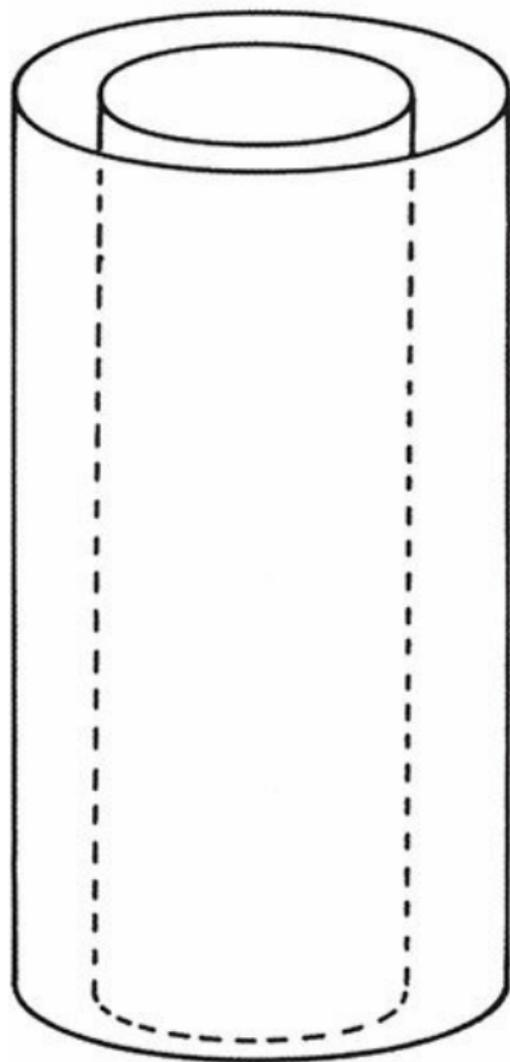
FIGURA 72. Aparelho para o experimento de Taylor-Couette (esquema). O espaço entre dois cilindros é preenchido com fluido, e os cilindros são girados. A distância entre os cilindros foi exagerada aqui, para efeito de maior clareza: em geral é de 10 a 20% do raio do cilindro externo.
