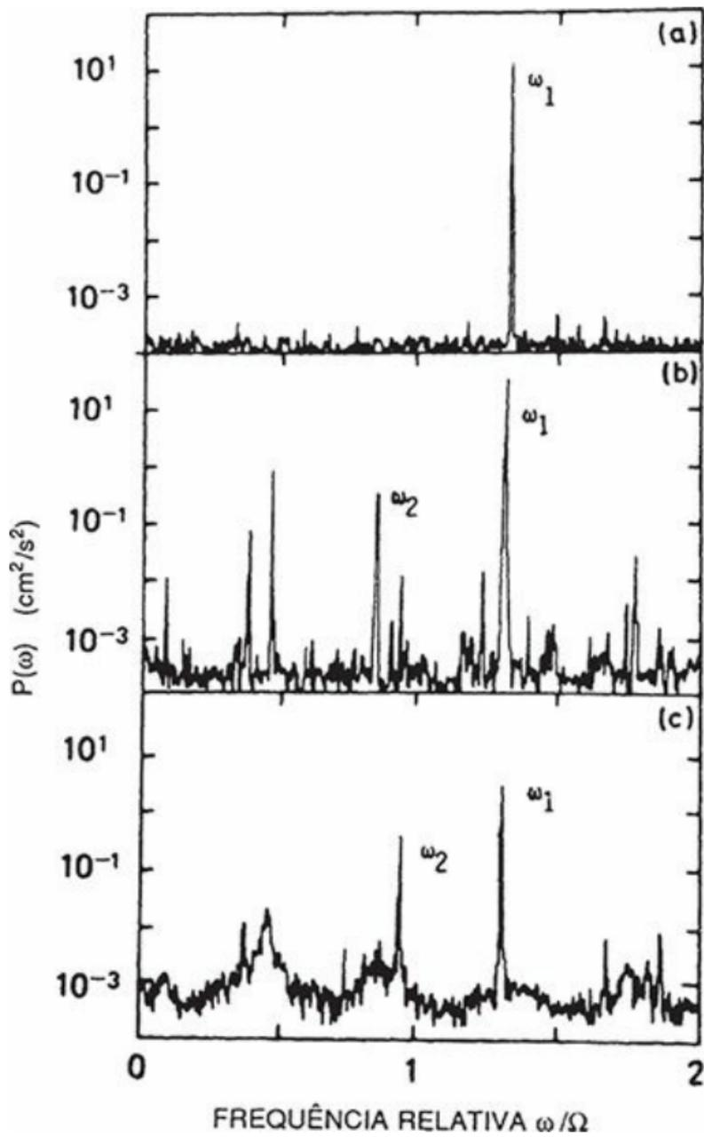
FIGURA 75. Espectro de potência para o sistema de Taylor-Couette. Inicialmente, só uma frequência  $\omega_1$  é observada (oscilação periódica). Depois uma segunda frequência  $\omega_2$  aparece (juntamente com outras pontas que representam combinações de  $\omega_1$  e  $\omega_2$ ). Por fim, bandas largas de caos podem ser vistas. (Reproduzido com a permissão de John Wiley & Sons Ltd.)
