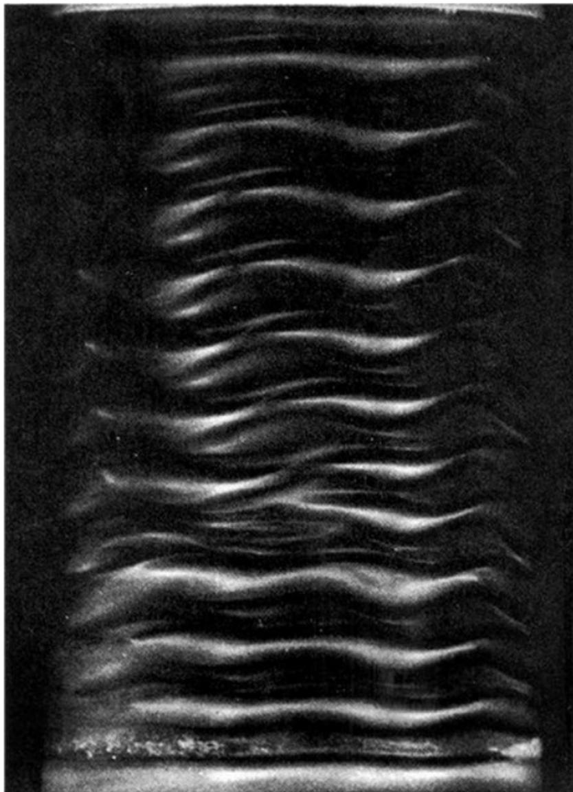
FIGURA 73. Vórtices ondulados no experimento de Taylor-Couette. Observe o deslocamento, a dois terços do caminho, de cima para baixo, onde o número de ondas no processo está se modificando.
