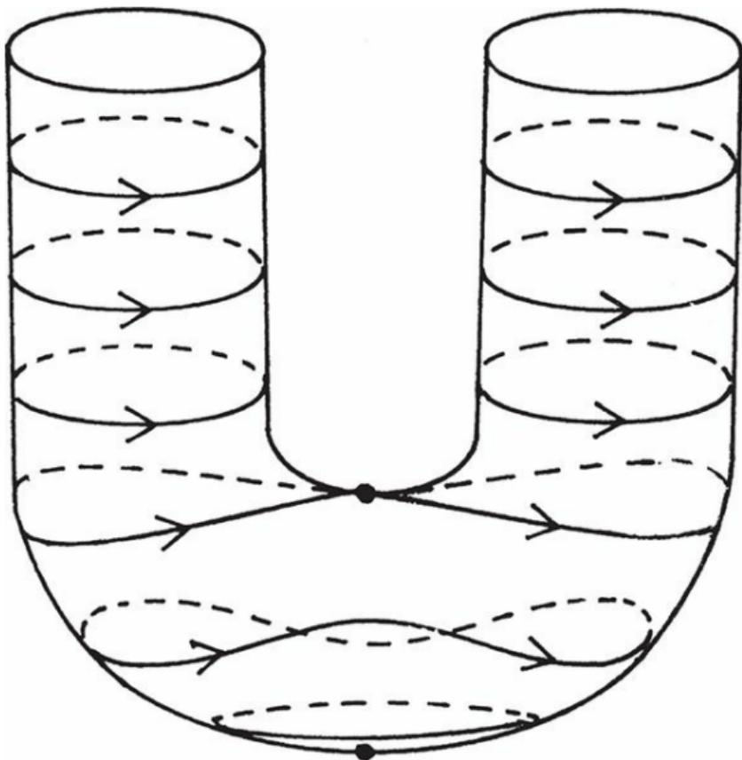
FIGURA 32. Representação geométrica da conservação da energia. Se o espaço de fase cilíndrico de pêndulo for encurvado, na forma de um tubo em U, as trajetórias permanecem em alturas constantes.
