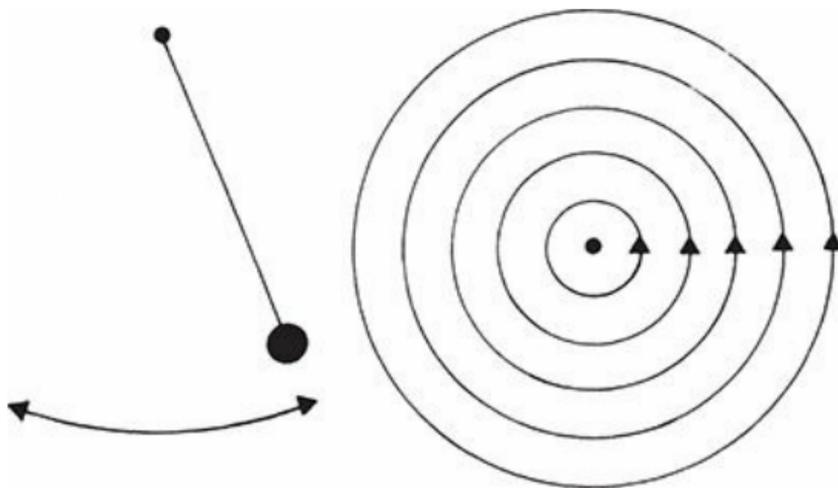
FIGURA 28. Retrato de fase (à direita) de um pêndulo linear idealizado (à esquerda). A coordenada horizontal é sua posição, a vertical, sua velocidade. À medida que o tempo flui, o estado do pêndulo descreve um círculo. Qual será ele, depende das condições iniciais.
