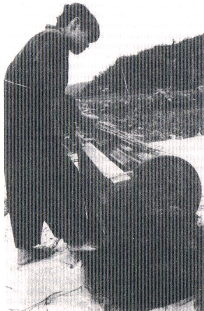
Debulha de cereais no tradicional tambor rotativo de pedais (Quioto). Depois, o grão é joeirado e enceleirado; a palha é devolvida aos campos.
