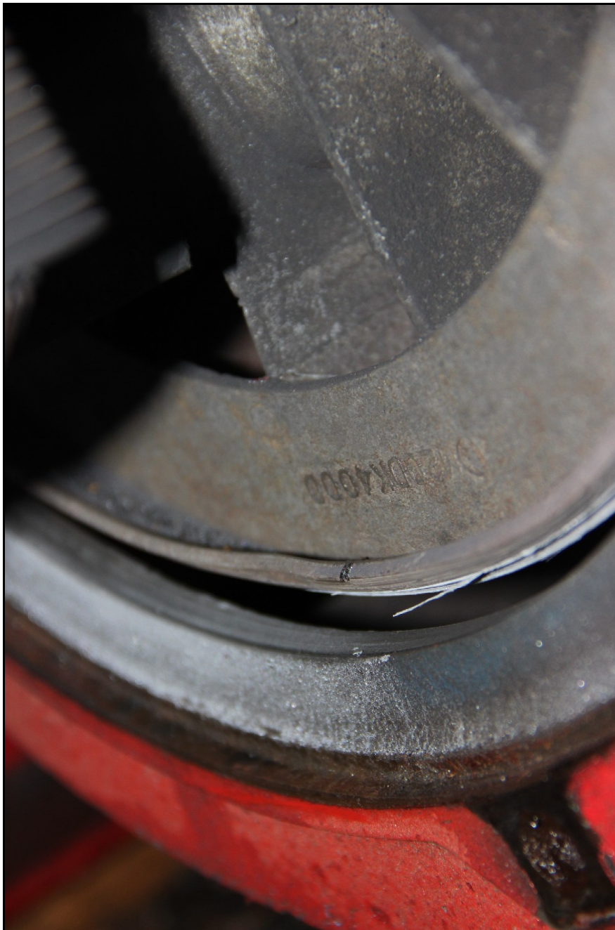
Photo 7 : L'extérieur du volant a été bouffé.
